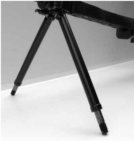
Bild 7: Verstellbare Zweibeinstütze zu Stgw 57, diverse Fabrikate
