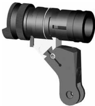
Bild 9: Universalkornträger zu Stgw 57 (Normalmontage), diverse Fabrikate
